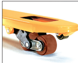
Tandem vorkrollen 2 Vorkrollen in iedere vork, gelagerd. Is een voordeel bij het rijden over een oneffen vloer en bij het rijden over groeven en drempels. Rollen aan voorkant vork
